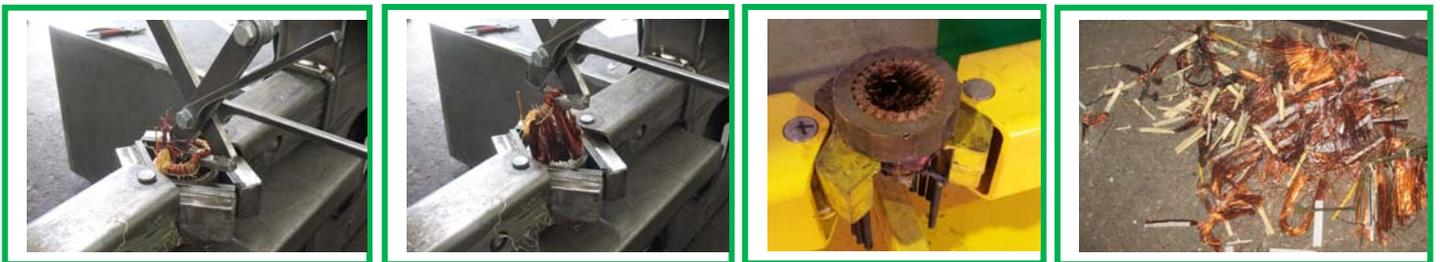
N.B. In alcuni casi, in fase di estrazione, il rame si può rompere. Questo è dovuto alla resistenza troppo elevata delle resine di bloccaggio utilizzate per la realizzazione dei motori. In tal caso si consiglia di riscaldare ad una temperatura adeguata lo statore, seguendo le indicazioni di sicurezza ambientale attualmente vigenti.
